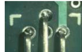
Fig. 6 Poor hole fill
